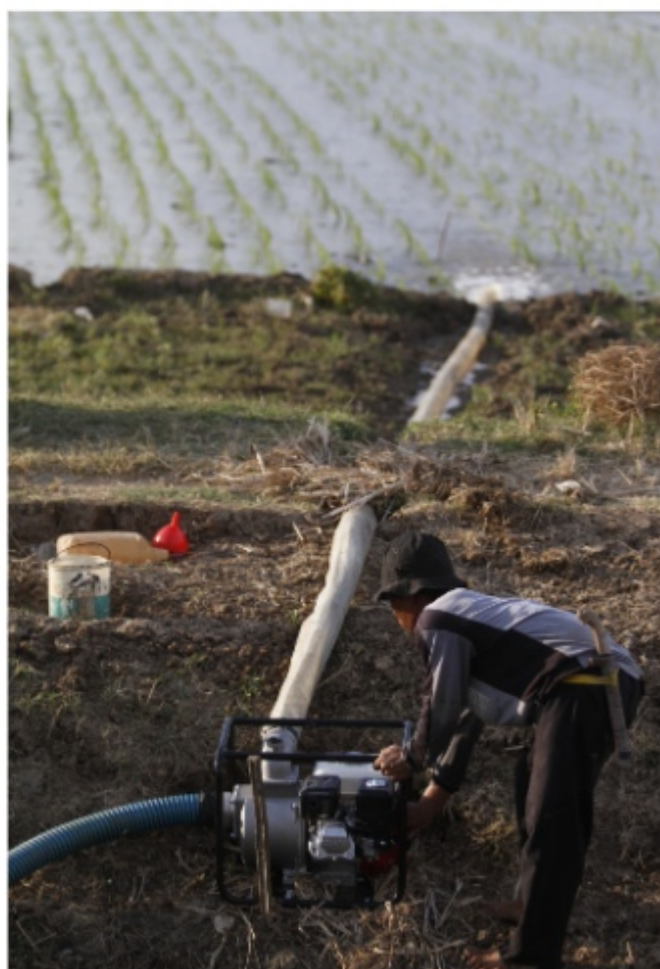
(atas dan bawah) Air dari Sungai Cipunagara yang disedot oleh pompa dialirkan ke saluran pengairan.
