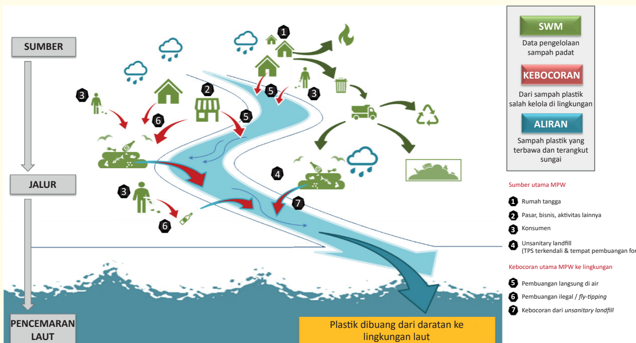
Gambar 16: Kerangka konseptual yang menggambarkan kebocoran dan pengangkutan sampah plastik dari sumber berbasis darat melalui sungai
