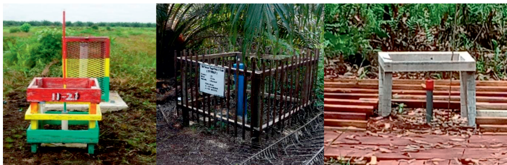
Gambar 7.3 Contoh-contoh Sumur Pantau di PT SR Kalimantan Barat, PT KS Sumatera Selatan dan PT MTI Kalimantan Barat (Dalam Supervisi Deputi III BRG RI, 2019) Kontributor foto: Budi L. Triadi
