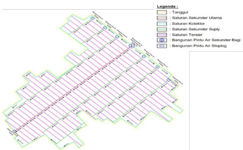
Gambar 6.42 Skema Jaringan Irigasi Pada Polder PT Buyung Poetra Sembada Sumber : Balai Besar Wilayah Sungai Sumatera VIII
