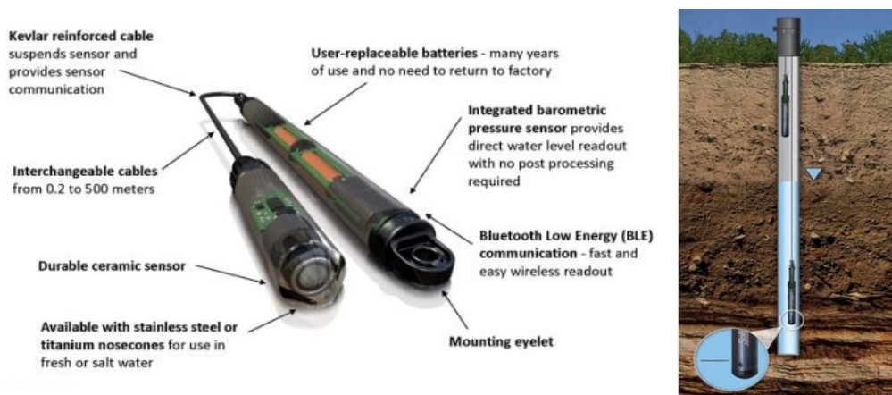
Gambar 7.4 Alat Ukur Tinggi Muka Air Tanah Otomatis (Logger) Sumber : Onset Data Loggers, 2015
