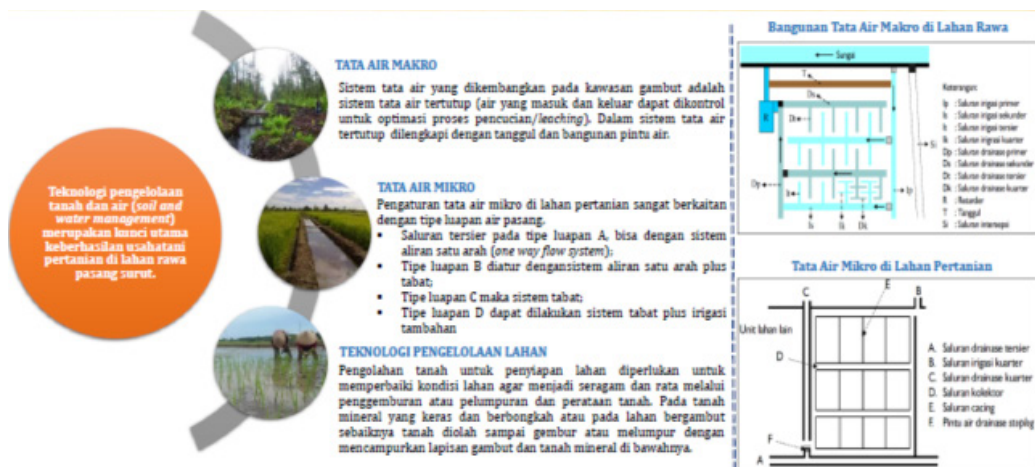
Gambar 6.34 Prinsip perencanaan Saluran pembawa dan pembuang yang terpisah pada irigasi pasang surut
