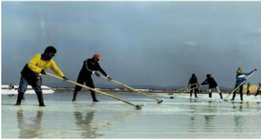
Gambar 8.1 Proses pemungutan garam dari meja kristalisasi di ladang garam milik PT. Garam (Persero) di Madura (Foto: http://members.bumn-ri.com/garam/graphics.html )
